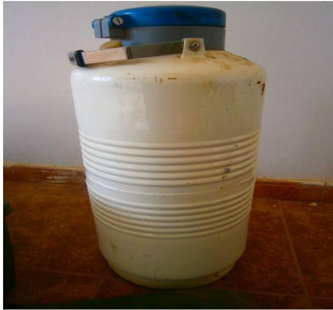
Photo 9: la bombonne d'azote liquide (-196°C) contenant les semences
