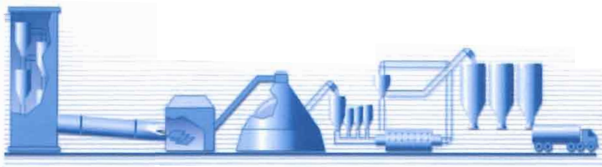
Fig.2.2 synoptique cuisson-broyage vers expédition ciment
