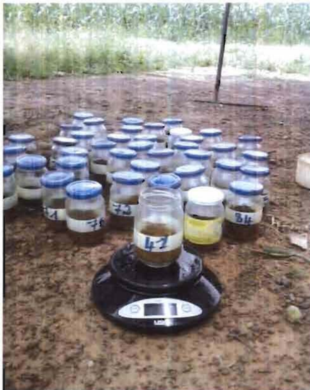
Pesage des échantillons de sol immédiatement après le prélèvement.
